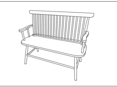
**Step 6:** PUT THE BENCH UPRIGHT AND MAKE SURE ALL LEGS ARE LEVEL, THEN FIRMLY TIGHTEN BOLTS WITH ALLEN KEY (HW8) WHILE THE BENCH IS UPRIGHT AS PICTURE ABOVE.
