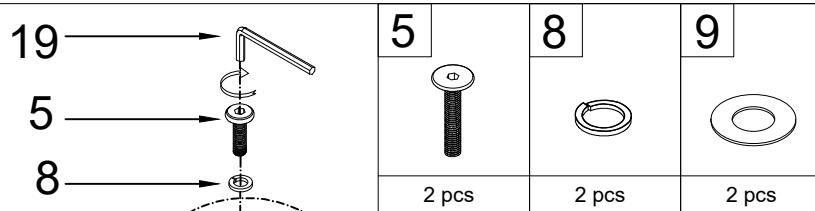
Étape 8 : Assemblez les lattes (S) au rail de support arrière (O) à l'aide des Boulons à tête hexagonale (5), des Rondelle élastique (8), des Rondelle plate (9) et de la Clé hexagonale (19), en vous servant du guide.
