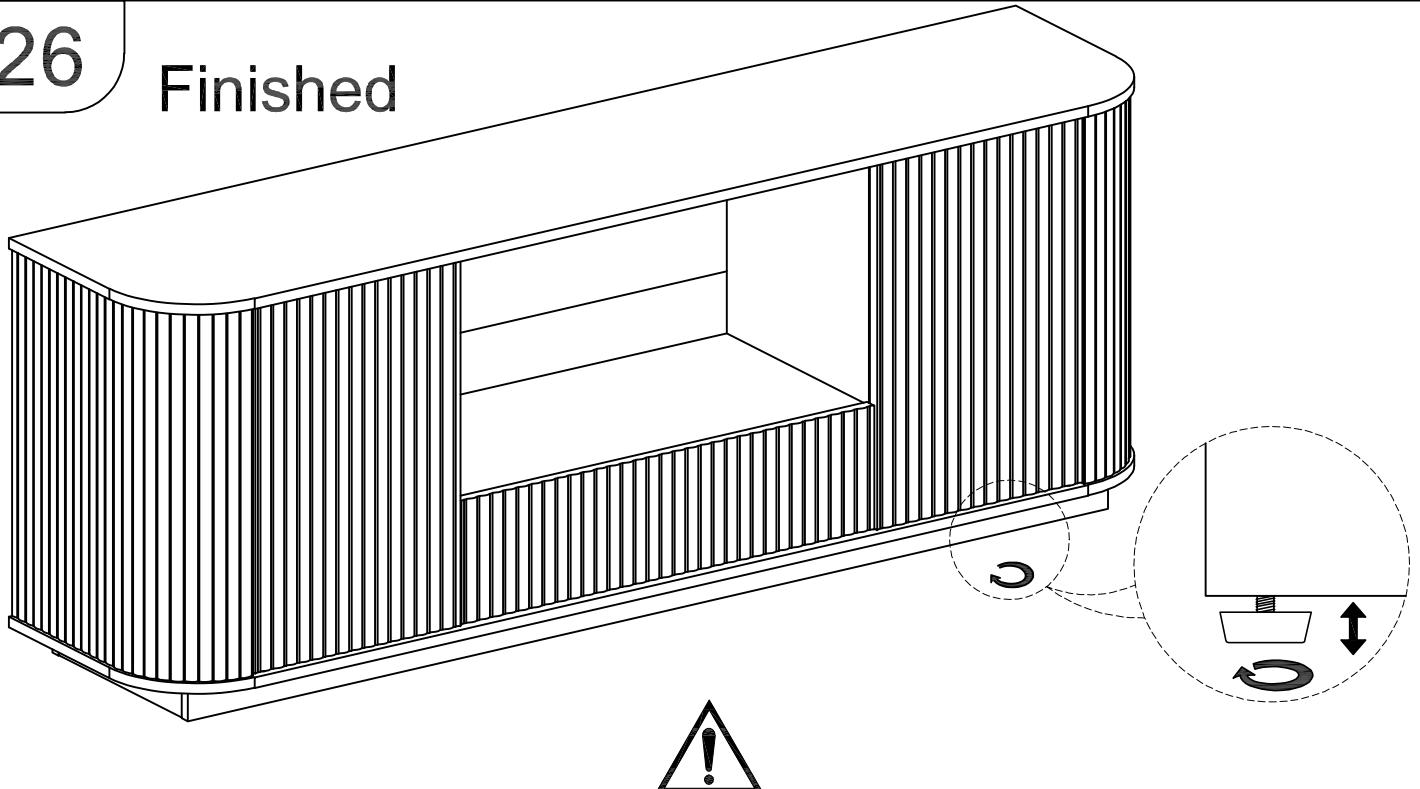
NOTE: USE THE LEVELING FEET TO MAKE SURE FURNITURE IS LEVEL ON THE FLOOR BEFORE USING. LEVELING THE CABINET MAY AFFECT THE LEVEL OF THE DOORS.
