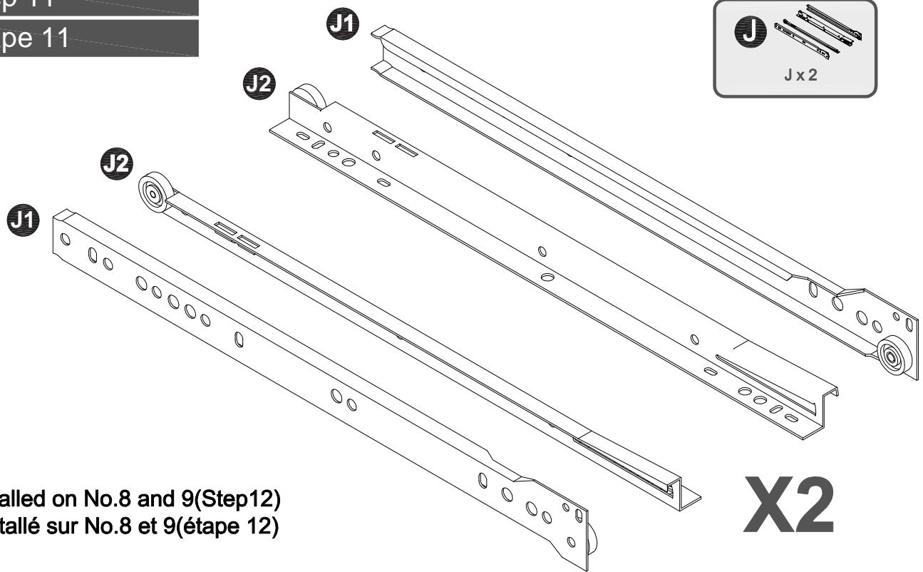
J2 installed on the bottom of the drawer.(Step 29)/J2 installé sur le fond du tiroir. (étape 29)
