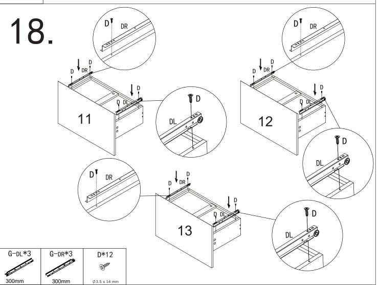
Please adjust the height of the feet to the balance of the cabinet and install the drawers Veuillez ajuster la hauteur des pieds à l'équilibre de l'armoire et installer les tiroirs
