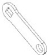
F04 LINKAGE STRAP - A4M02225 (x1) 1/8"x13/16"x2 5/8" (3x20x66)
