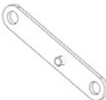
F03 LINKAGE STRAP - A4M02229 (x1) 1/2"x11/16"x3 13/16" (13x17x97)
