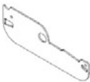
L03 LOUVER SIDE PLATE - A4M02334 (x55) 1/16"x2 3/16"x6 9/16" (2x55x167)
