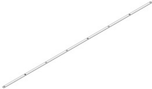
F01 FLAT BAR - A4M02572 (x4) 1/16"x1"x92 13/16" (2x25x2357)
