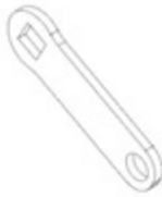
F04 LINKAGE STRAP - A4M02225 (x1) 1/8"x13/16"x2 5/8" (3x20x66)
