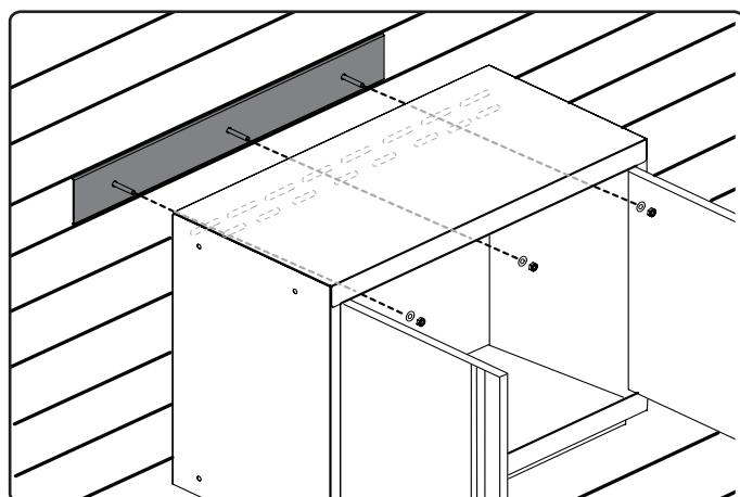
**Remarque : Pour l'armoire-vestiaire, fixer le deuxième support à 66 po au-dessous du premier support. Pour l'armoire sur plancher, fixer le deuxième support à 18 po au-dessous du premier support.**
