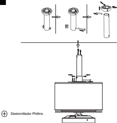
Como se muestra en la figura, retire la bola de suspensión de la varilla de suspensión y pase el cable de alimentación del ventilador principal a través de la varilla de suspensión.
