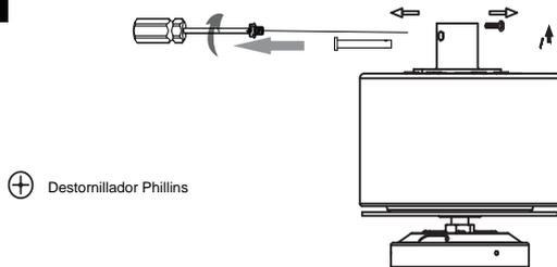
Extraiga el ventilador principal de la caja de embalaje, como se muestra en la figura. Retire el pasador de suspensión y el pasador de bloqueo R, y utilice un destornillador para aflojar los dos tornillos laterales.
