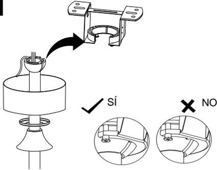
Como se muestra en la imagen, el ventilador principal está fijado a la placa de suspensión,
