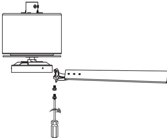
Verrouiller les 8 éléments du porte-lame sur le moteur
