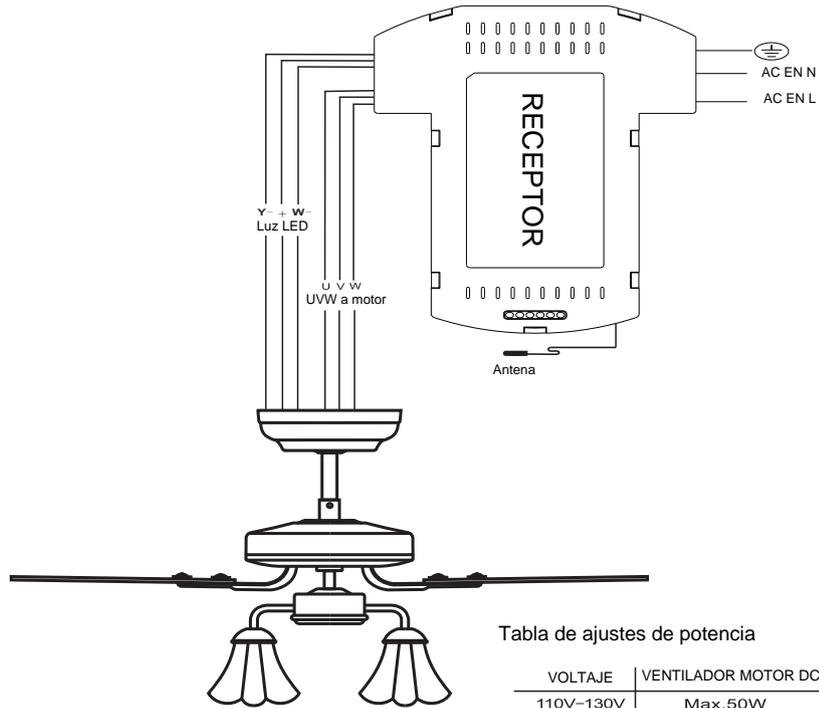
Utilice las tuercas de conexión de cables suministradas con el mando a distancia.
