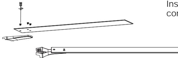
Installer le porte-lame et le raccord de lame comme indiqué dans les étapes de l'image
