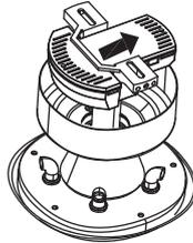
1. Empuje suavemente el dosel hacia la parte inferior del soporte de montaje, deslice los dos orificios alineados sobre los dos tornillos prominentes del soporte de montaje, luego gire en el sentido de las agujas del reloj hasta que quede ajustado.
