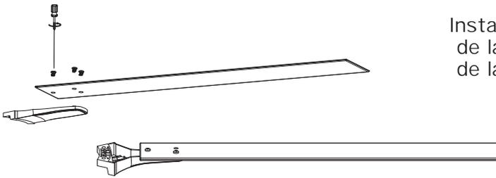
Instale el soporte de las aspas y el conector de las aspas como se muestra en los pasos de la imagen.
