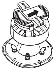
1. Pousser délicatement la verrière jusqu'au bas du support de montage, faire glisser les deux trous alignés sur les deux vis proéminentes du support de montage, puis tourner dans le sens des aiguilles d'une montre jusqu'à ce qu'elle soit bien serrée.
