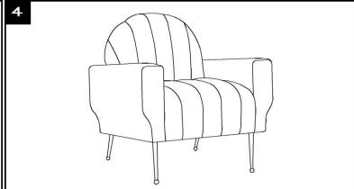
**STEP 4:** PUT THE CHAIR UPRIGHT AND MAKE SURE ALL LEGS ARE LEVEL, THEN FIRMLY TIGHTEN BOLTS WITH ALLEN KEY WHILE THE CHAIR IS UPRIGHT AS PICTURED ABOVE.
