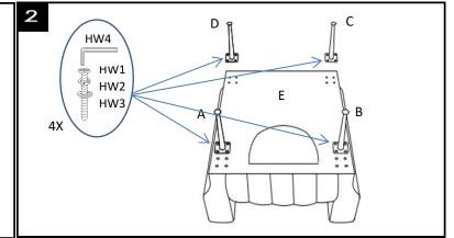
**STEP 2:** PUT THE WASHERS ON THE SCREW IN THE ORDER SHOWN IN THE PICTURE, INSERT THE LEGS AND SCREW IN THE SCREWS BUT DON'T TIGHTEN COMPLETELY. REPEAT THE SAME STEPS FOR THE OTHER THREE LEGS.
