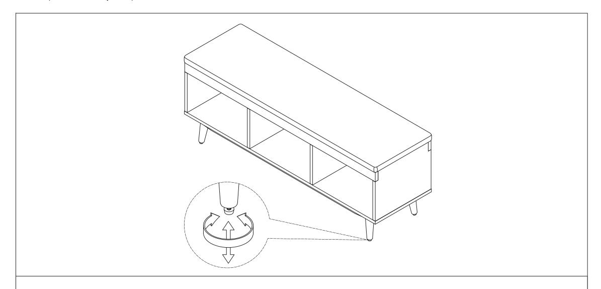
STEP 9 ADJUST THE ADJUSTER THAT HAS ALREADY BEEN ASSEMBLED TO THE LEGS TO STABILIZE YOUR UNIT.
