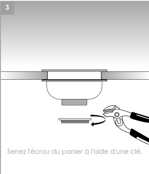
Serrez l'écrou du panier à l'aide d'une clé.
