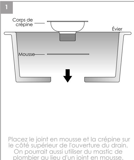
Placez le joint en mousse et la crêpine sur le côté supérieur de l'ouverture du drain.
