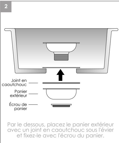
Par le dessous, placez le panier extérieur avec un joint en caoutchouc sous l'évier et fixez-le avec l'écrou du panier.
