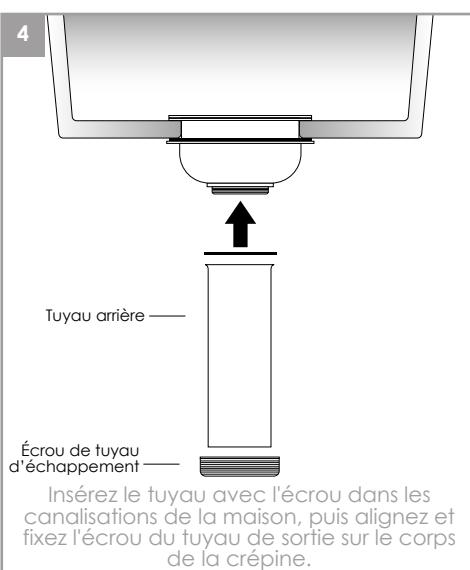
Insérez le tuyau avec l'écrou dans les canalisations de la maison, puis alignez et fixez l'écrou du tuyau de sortie sur le corps de la crêpine.
