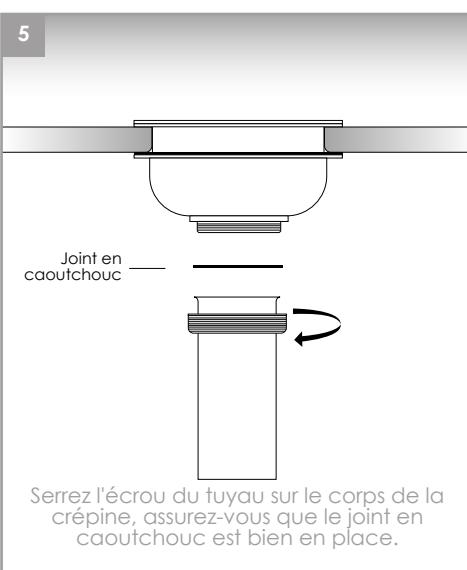
Serrez l'écrou du tuyau sur le corps de la crêpine, assurez-vous que le joint en caoutchouc est bien en place.
